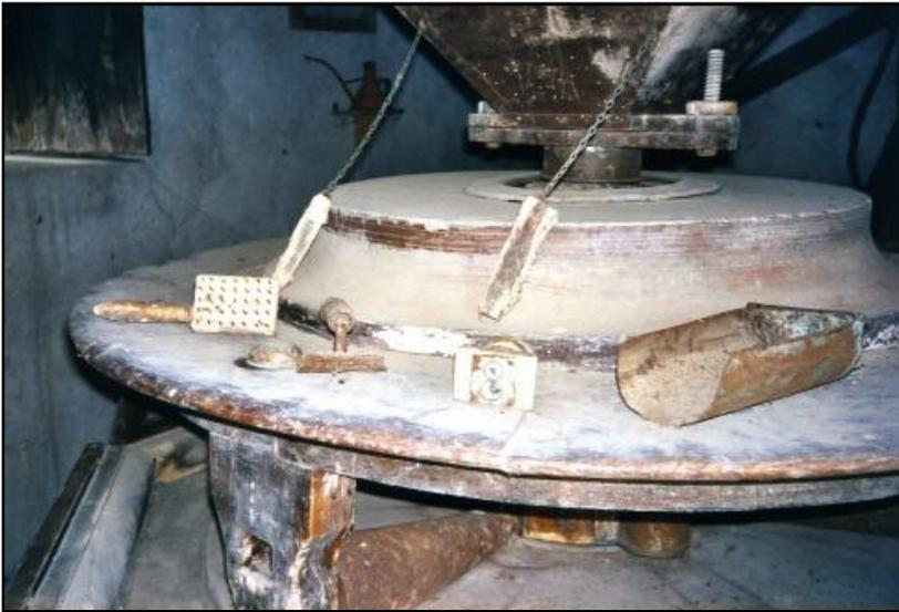
La zona en la que se encuentra la piedra está protegida por seis rejillas abatibles con marcos de madera que, por un lado, impedían que el cacao cayese del molino durante el proceso y, por otro, permitía el acceso y la manipulación de la pasta.
